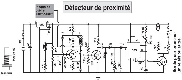
T2 : faible signal, faible bruit, 100 MHz, transistor crucial, doit amplifier d'environ 10 fois, hfe de 180
